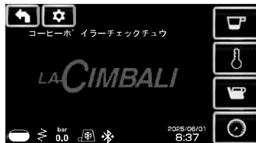
メインボイラーの圧力が設定圧力（工場出荷設定は1.1 bar）に到達すると、**≡** マークのアニメーションが止まり、ウォーミングアップ完了です。
