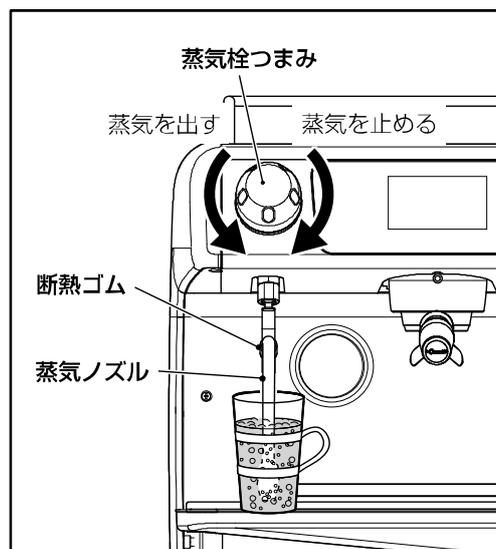
『蒸気栓つまみ』を反時計方向に回して蒸気を出してください。
