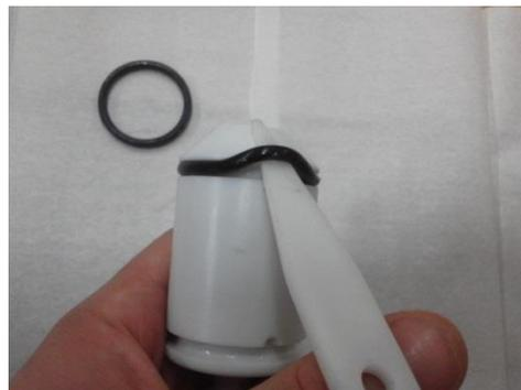
⑥ スポンジとブラシで部品を洗浄します。洗剤と水で洗浄します。特に部品の溝はよく洗ってください。ピーター軸の内側も、専用ブラシで洗浄してください。
