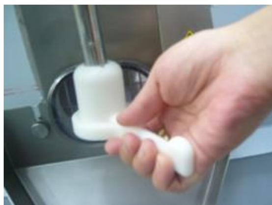
③レバーの溝と軸の突起部分をかませて上に持ち上げます。
