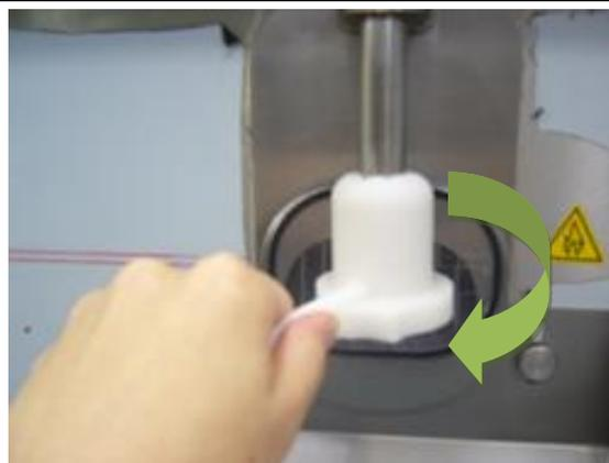
⑤レバーを右に回し、アイスクリームドアを固定します。オーリングにジェリリチューブを塗布し、装着します。
