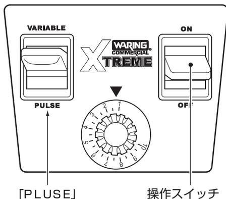
無段階変速ダイヤルは、目盛「1」の位置で1,300 rpm、「10」の位置で25,000 rpmまで無段階に変速します。
