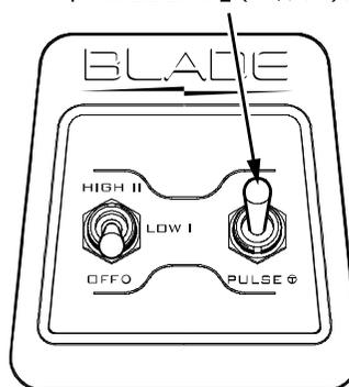
操作スイッチを「OFF」(切)にして、電源プラグを抜いてください。
