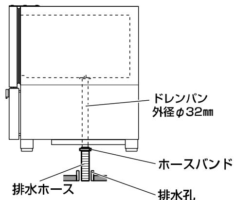
3. ドレンパイプに接続した排水ホースの先端を排水孔または排水溝に差し込んでください
