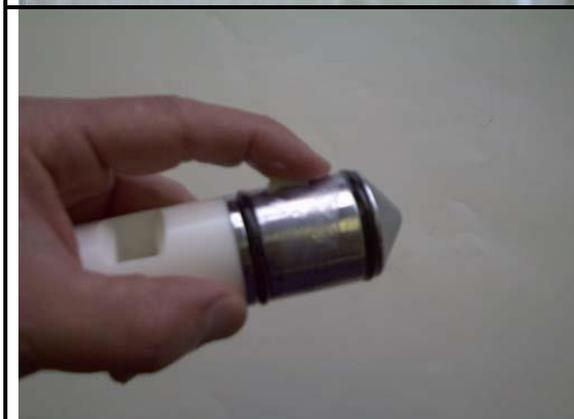
A hand is shown holding a metal piston with two black O-rings (135) attached to its side.                                                                                                                                           | <p>〔55〕<br/>ピストンにオーリング 135 を 2 個ずつはめ込みます。<br/>オーリングとピストンの金属部分全体にジェリリユーブを塗布します。</p>                                 |
