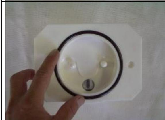
The final assembly is shown. The white plastic Spi-got head housing is held in place, and a large black O-ring (186) is being fitted around the perimeter of the housing.                                                          | <p>〔57〕<br/>スピゴットヘッドの裏側にオーリング 186 をはめ込みます。<br/>オーリングにはジェリリユーブを塗布します。<br/>組み立て作業終了です。</p>                           |
