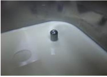
タンク内ミックスが **5リットル**以下になるとディスプレイに“ミックスツイカ”メッセージが表示されます。操作パネルの原料補充ランプが点滅します。
