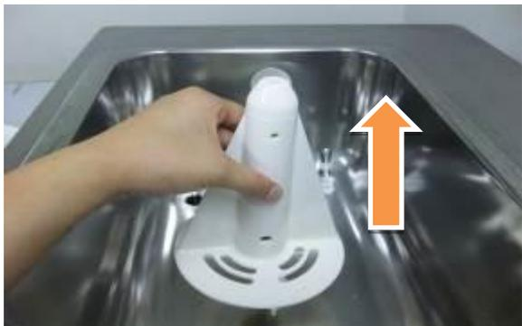
⑤ タンク内攪拌ピーターを上引き抜きます。
