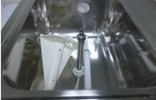
⑥タンク内部品（攪拌ビーター、ドリップチューブ）をタンク淵に置きます。
