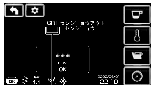
「1連目」を表しています。 「2連目」のエスプレッソ抽出アイコンをタップしたときはGR2と表示されます。
